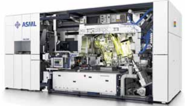
ASML'in ürettiği litografi cihazı çip üretiminin en temel bileşeni
